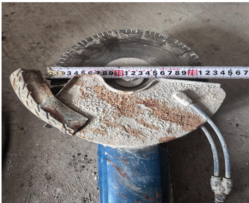
图3 角向磨光机刀盘
