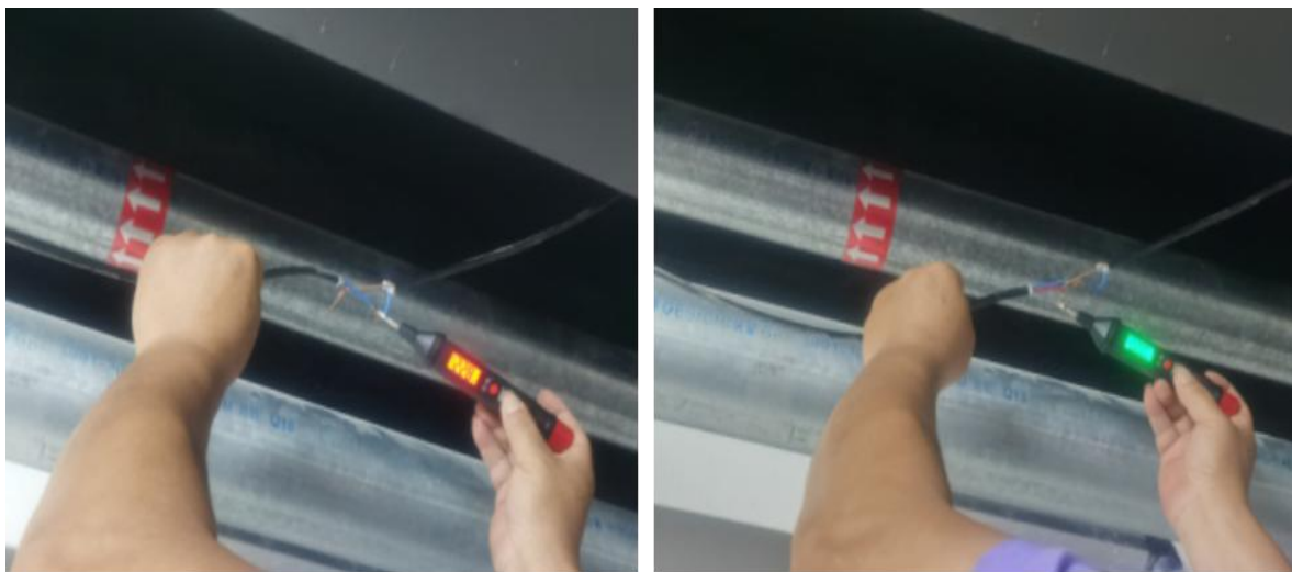
图4 汇聚箱内插线板单联开关合上时，监控线路电压测试情况
