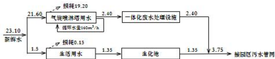
图2-1项目水平衡图 单位: m 3 /d
