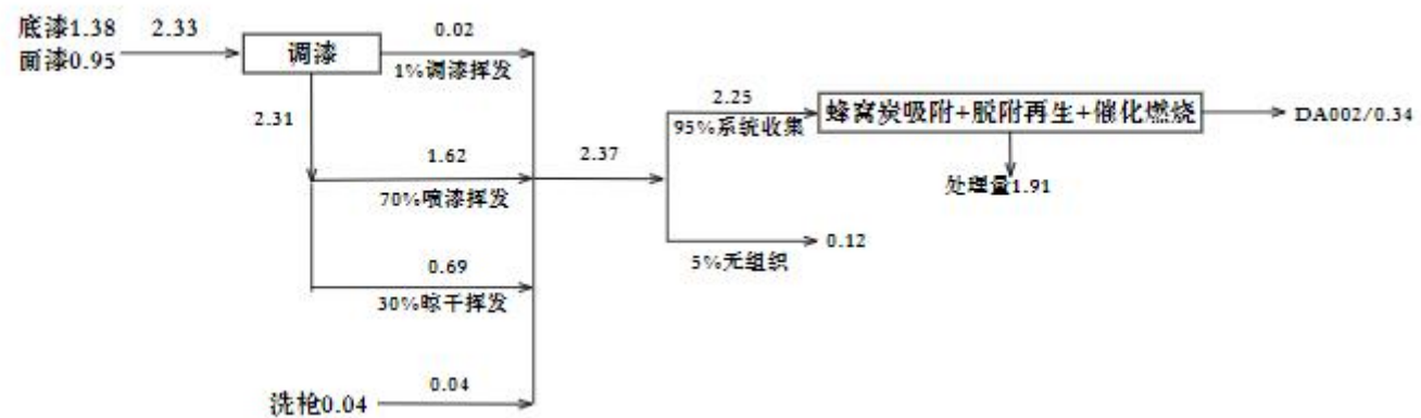
图2-3项目非甲烷总烃平衡图 单位: t/a
